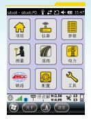
SurPad软件集工程测量、电 力勘测、GIS属性数据采集 为一体。多种坐标转换参数 计算模型,兼容各种主流转 换参数。
