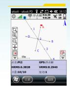
内置电力勘测、塔基放样功 能模块,测量数据可导出道 亨和思维等常用格式。
